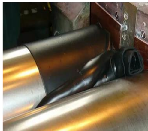
Рисунок 2.3 – Процесс приготовления полимерной композиции, наполненной шунгитом
