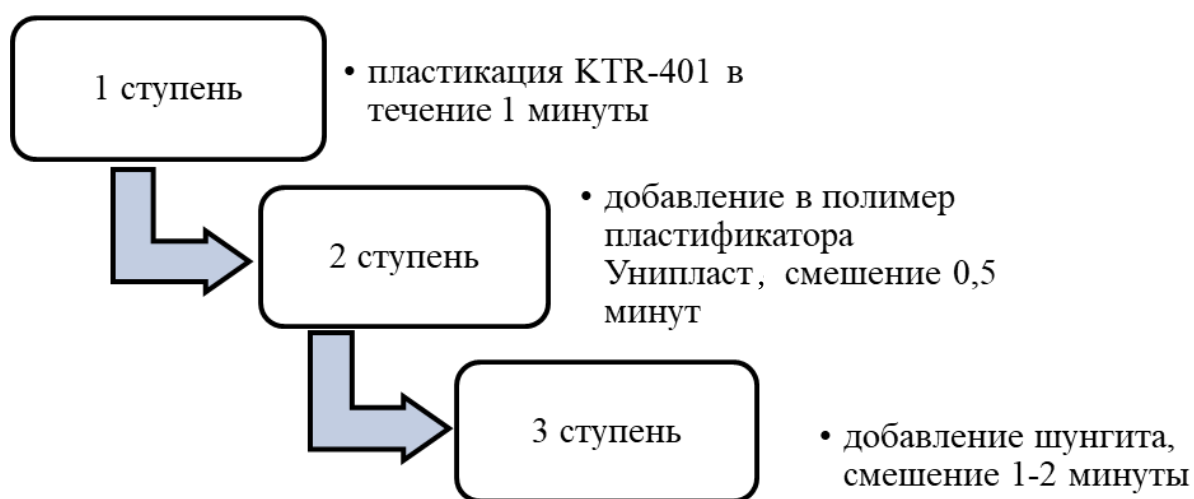
Рисунок 2.4 – Последовательность смешения компонентов композиции
